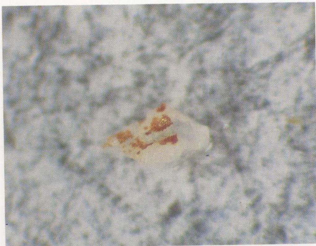
Figura 9 A.—Micrografía de un grano con inclusiones rojas y su correspondiente imagen de electrones retrodispersados.
